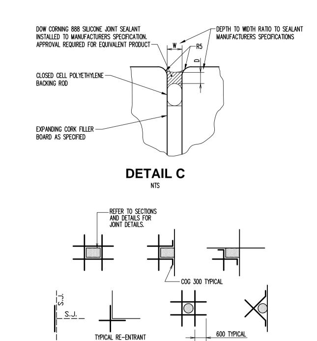
TYPICAL SLAB ON GROUND TRIMMER DETAILS
