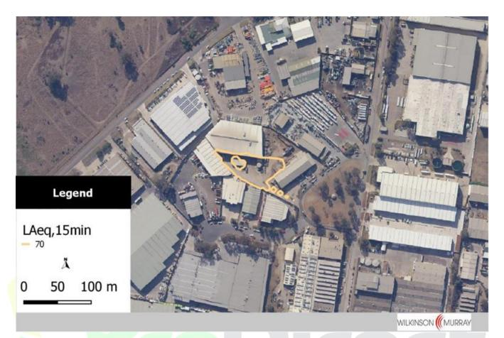
FIGURE 32 OPERATIONAL NOISE LEVEL CONTOURS AROUND THE BOUNDARY OF THE SITE
