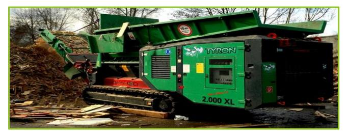
FIGURE 11 TYPICAL SLOW SPEED SHREDDER USED TO MINIMISE WOOD/TIMBER WASTE
