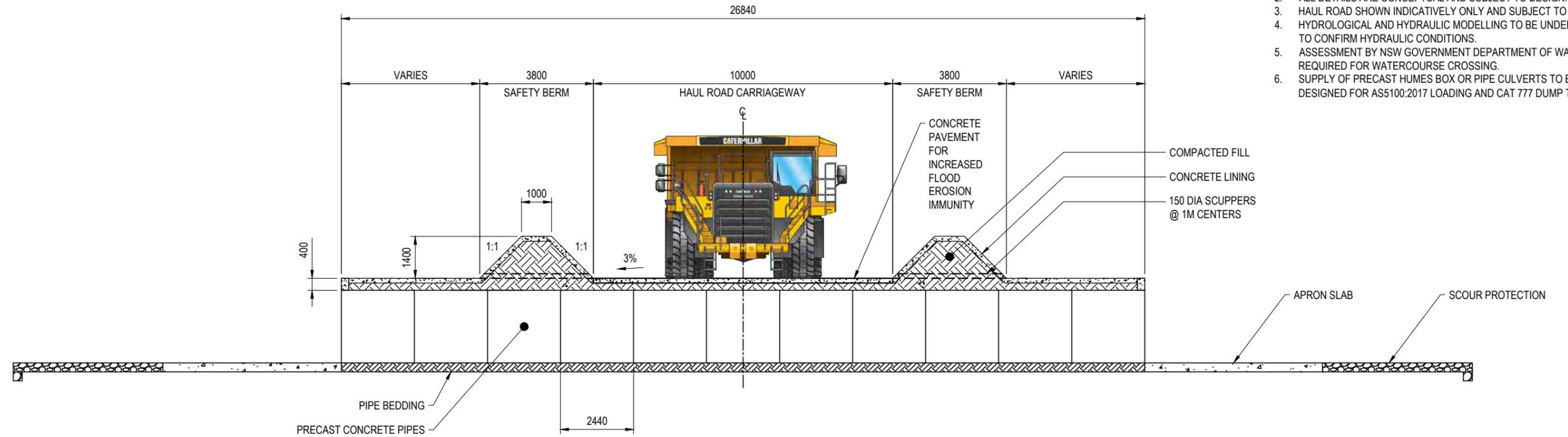
**TYPICAL SECTION ALONG CL OF CULVERT**
