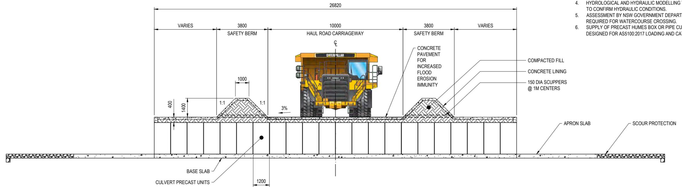
**TYPICAL SECTION ALONG CL OF CULVERT**
