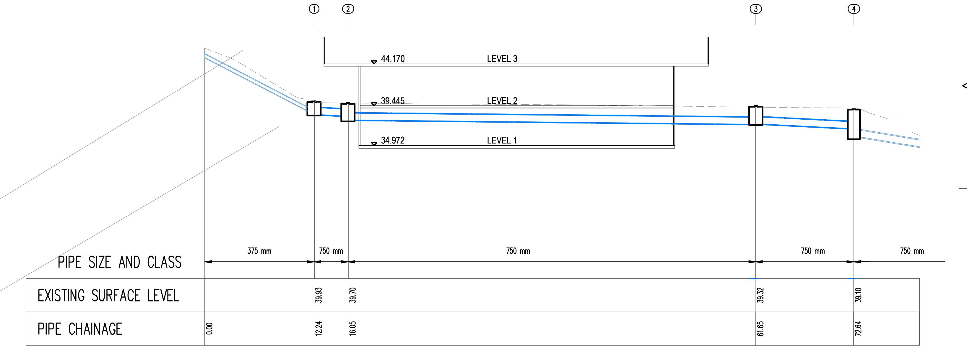
STORMWATER LONGITUDINAL SECTION
