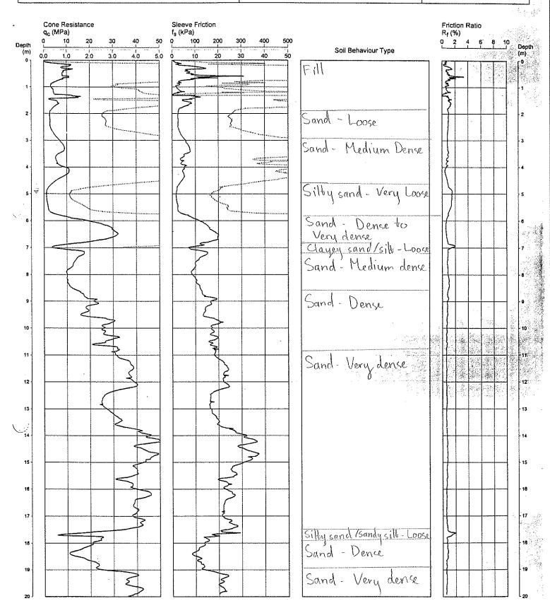
REMARKS: GROUNDWATER LEVEL AT COMPLETION OF TEST: 4.9 m \*LEVELLING TO BOREHOLE ON HOUSTON LANE TAKEN AS RL 25.9 m AHD.
