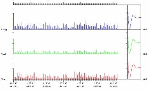
Time Scale: 15 minutes /div | Amplitude Scale: Geo: 0.500 mm/s/div
