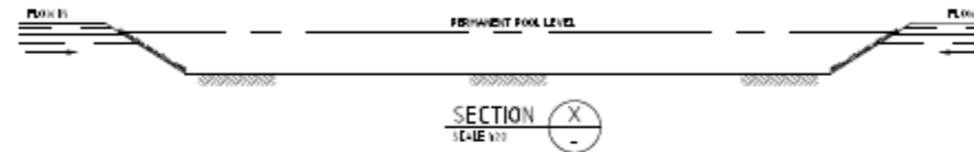
TYPICAL SEDIMENT BASIN N.T.S.
