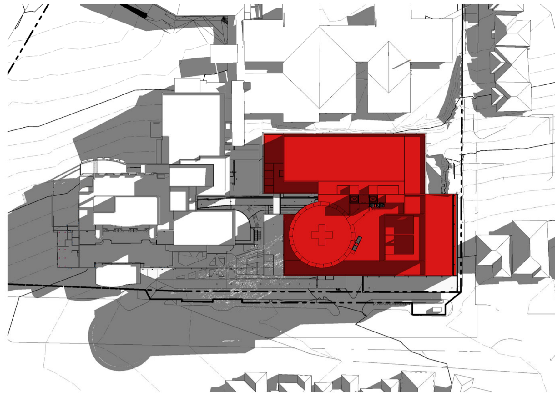
4 3B2 - SHADOW DIAGRAM - 22 JUN 9AM SCALE 1 : 1000
