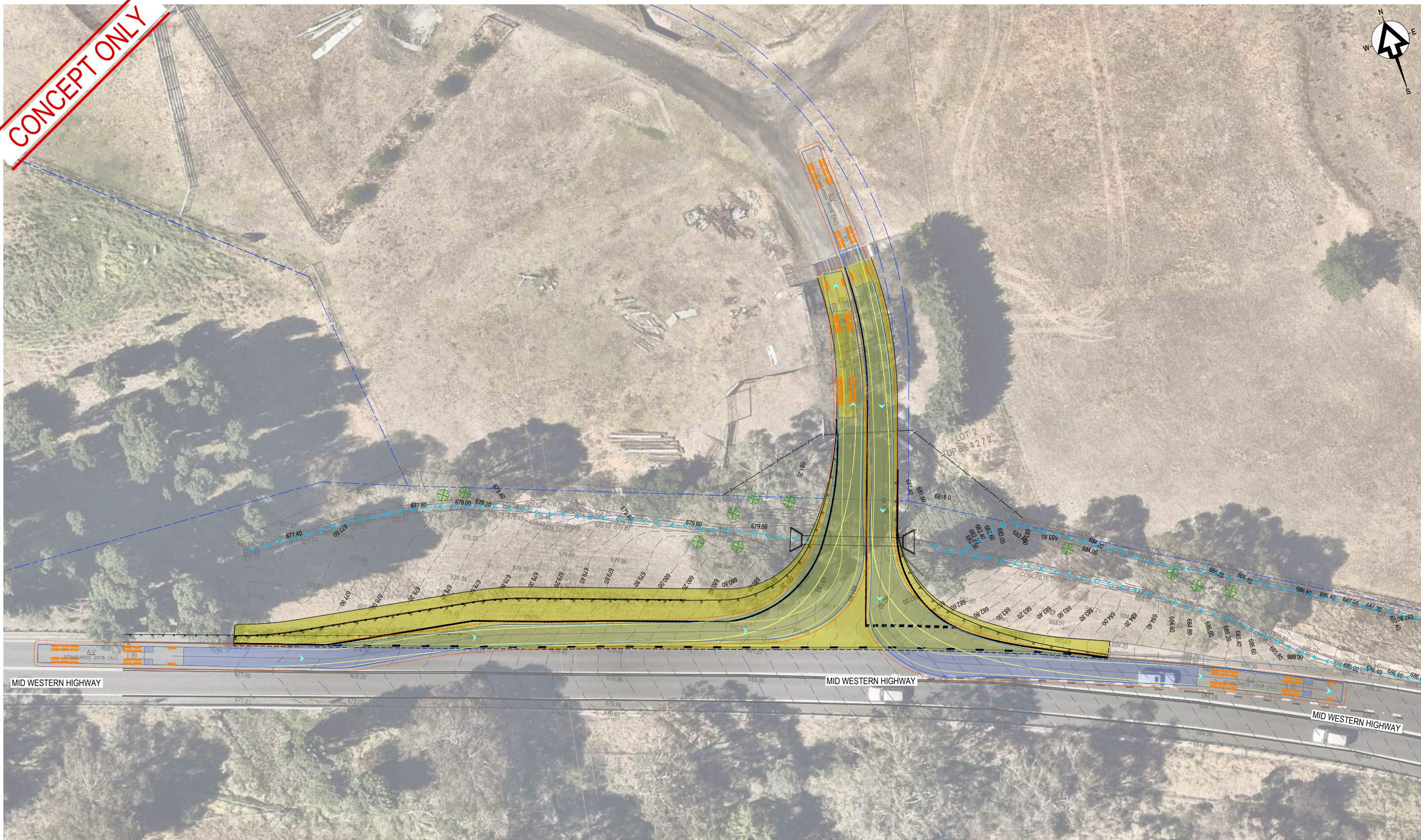
SWEPT PATH ANALYSIS - AV ENTERING/EXITING PROPERTY ACCESS SCALE 1:250
