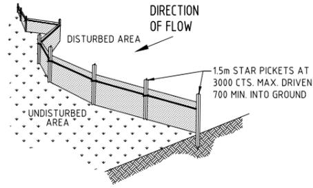
TYPICAL SILT FENCE DETAIL
