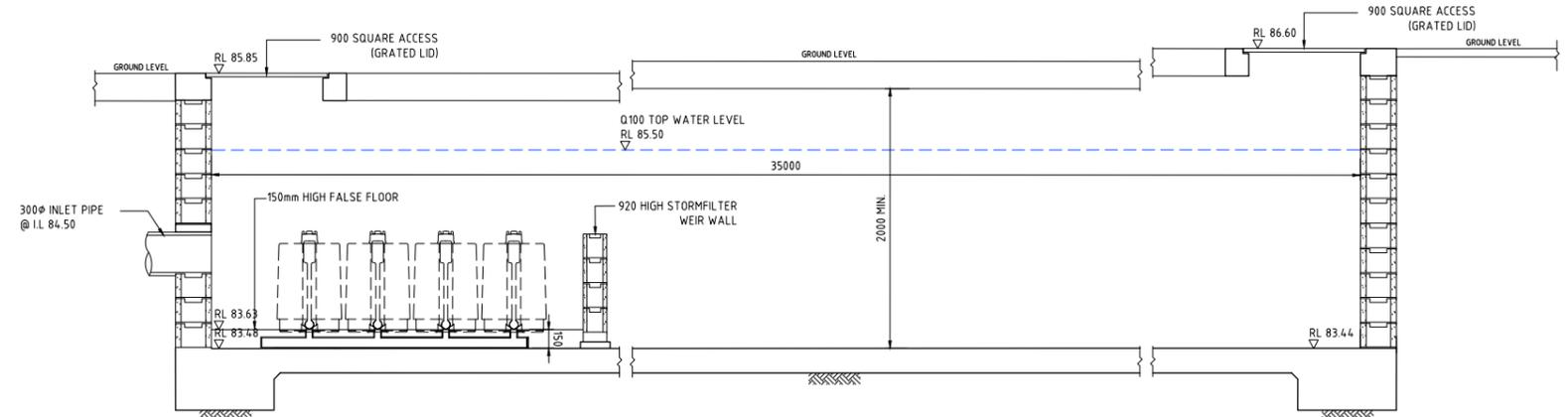
**SECTION 1:20** 2 : TYPICAL THRU TANK
