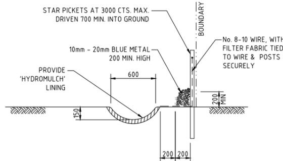
TYPICAL OPEN DRAIN & SILT FENCE
