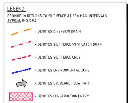
**EROSION SEDIMENT CONTROL PLAN**
