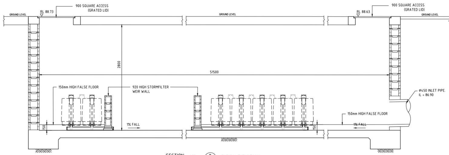
SECTION 1:20 2 : TYPICAL THRU' TANK
