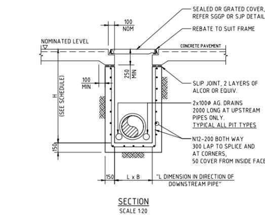
SJP/CIS & SGGP/CIS (CAST IN SLAB) PIT DETAIL
