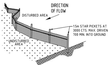
**TYPICAL SILT FENCE DETAIL**
