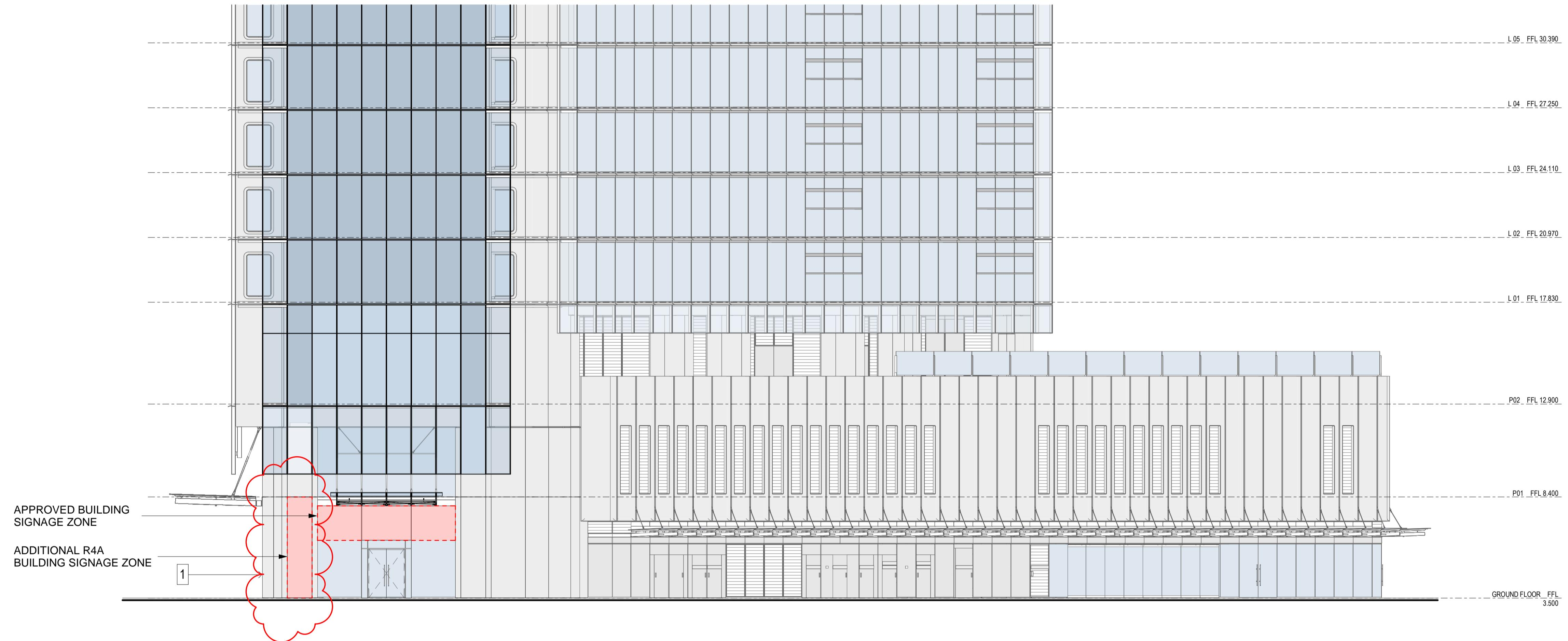
NOTE: FINAL INSTALLATION OF BUILDING IDENTIFICATION SIGNAGE IS LIMITED TO ONE SIGNAGE ZONE ONLY
