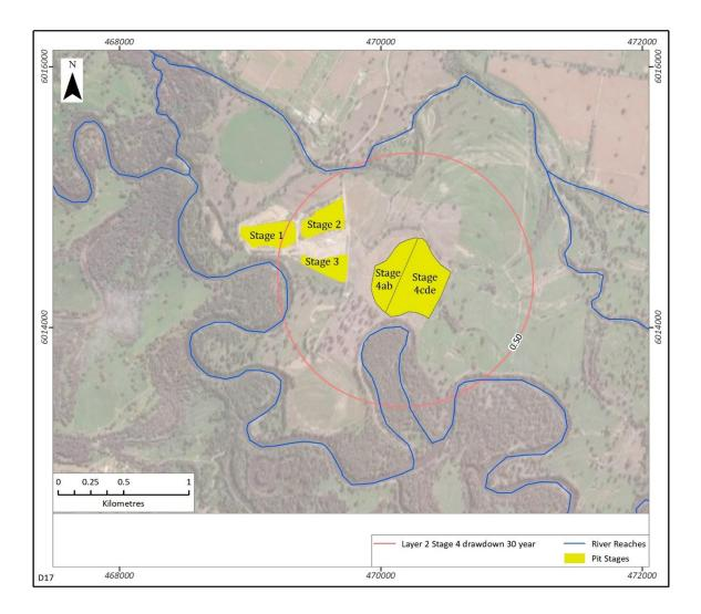
FIGURE 26: MODELLED LAYER 2 DRAWDOWN AFTER STAGE 4
